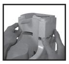
**ПРИМЕЧАНИЕ:** С правой стороны корпуса при этом ощущается некоторое сопротивление, так как трубка впуска воды отделяется от мотора.
