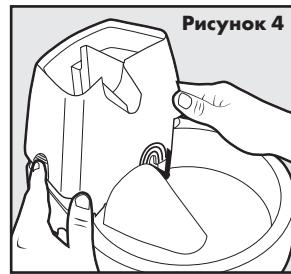
**Важно!** Ручка регулировки расхода подсоединенена к насосу. Не пытайтесь снять насос, потянув за ручку регулировки расхода, так как это может привести к повреждению или выходу насоса из строя.
